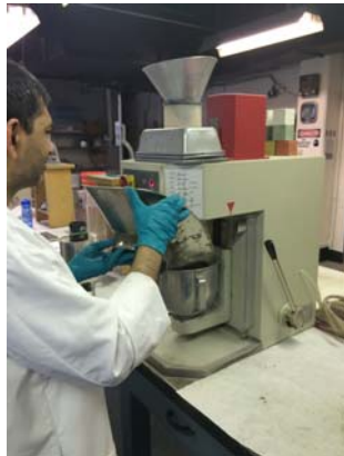
1. Mix per ASTM C305
